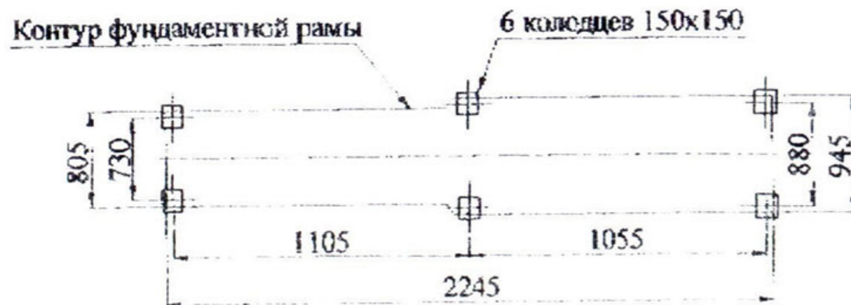
План расположения колодцев под фундаментные болты
