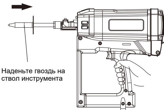
Гвоздь нужно надевать до его плотной фиксации на стволе инструмента.
