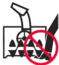
ОПАСНОСТЬ! вращающийся шнек
