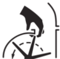
ОПАСНОСТЬ! вращающаяся крыльчатка
