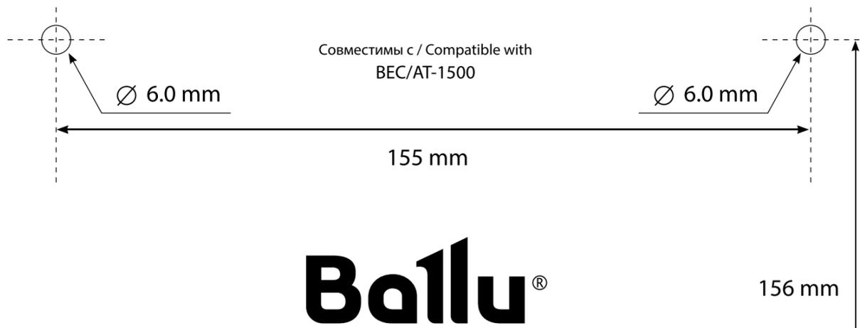
**Монтажный шаблон для отопительного модуля электрического конвектора Ballu Apollo Transformer system**
