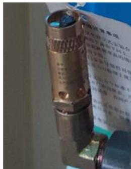
**Рис. 11 Предохранительный клапан**
