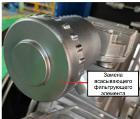
1. Откройте зажим корпуса воздушного фильтра и снимите его, как показано на рисунке
