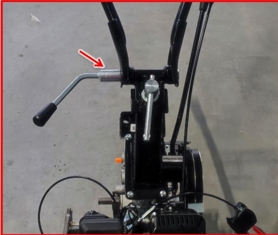
На правой ручке руля установить и закрепить рычаг газа крепежом (болт М6х50, гайка самоконтрящаяся М6 - в комплекте с ручкой).
