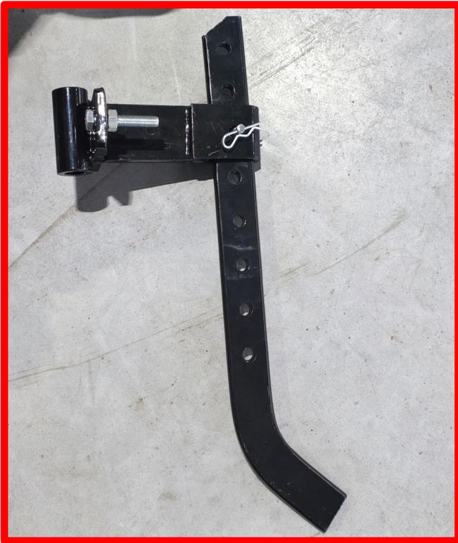
Установить и зафиксировать кронштейн крепления сошника с помощью 3х штифов  $\varnothing 16 \times 120$  со шплинтами.
