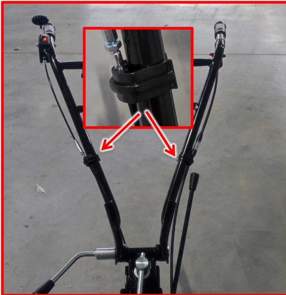
Установить ящик для инструментов на руль и зафиксировать крепежом (болт М6х14, гайка М6).
