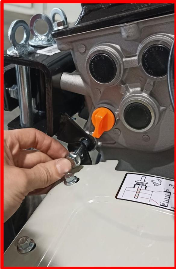
Зафиксировать крылья к раме в передней части культиватора используя крепеж (болт М8х60, гайка М8).
