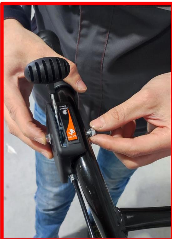
Зафиксировать трос газа и сцепления фиксаторами.
