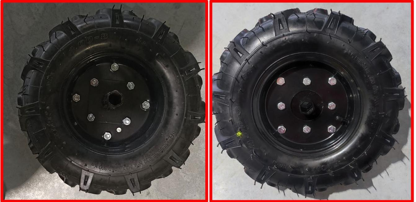
Установить собранные колеса на шестигранный вал редуктора и зафиксировать с помощью штифтов  $\varnothing 7 \times 45$  со шплинтами  $\varnothing 2 \times 35$ .
