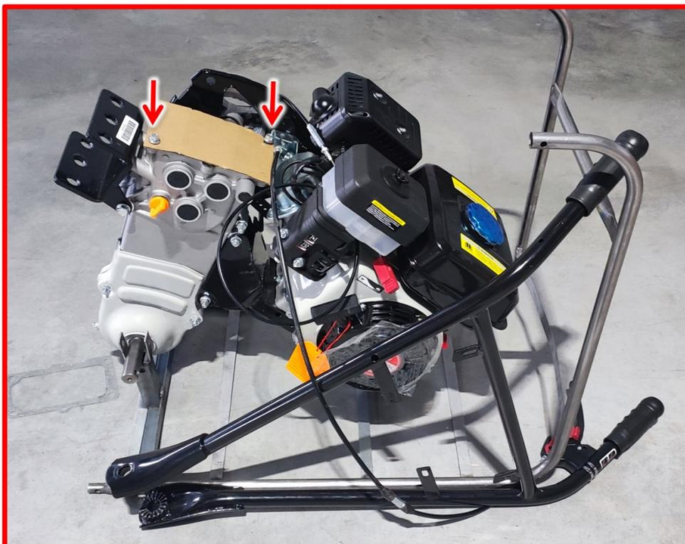
Совместив по отверстиям установить паронитовую прокладку на фланец редуктора.
